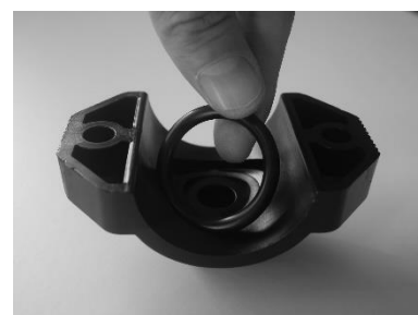
Figure 17 : Pose du joint torique sur le collier de prise en charges.
