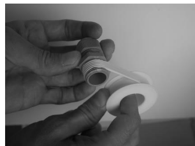
Figure 21 : Pose du joint téflon sur le porte-sonde.
