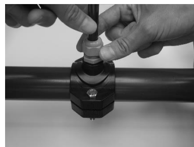
Figure 23 : Pose de la sonde pH/ORP sur le porte-sonde.
